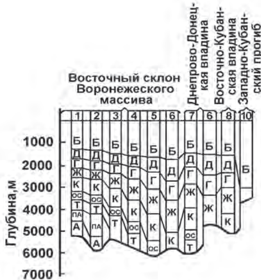
Рис. 91. Глубины расположения зон равной углефикации в различных районах Восточно-Европейской платформы и Предкавказья
