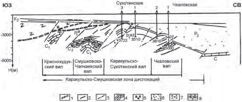
Рис. 9. Сейсмогеологический разрез через зону сочленения Восточно-Европейской и Скифской платформ (по В.Э.Г. Бембееву, В.П. Климашину, С.С. Скромкому [1985])
